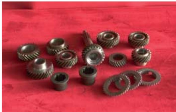
In alto a sinistra, la costruzione di particolari speciali per vetture da competizione comprende alcuni elementi appartenenti a vetture dal valore tecnico e commerciale notevole. Quelli visibili nella foto, relativi ad un cambio di velocità, sono fedeli ricostruzioni dell'apparato montato nei primi anni '60 sulla Ferrari 250 GTO.
