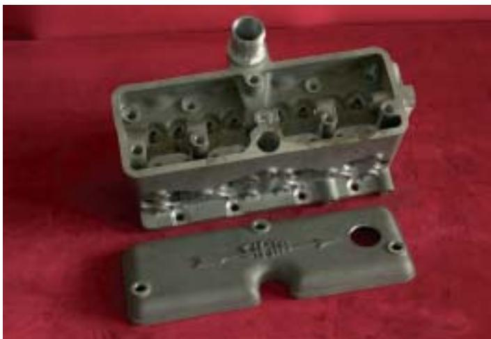
**In basso, i propulsori messi a punto dalla Siata sono stati ripresi dal tecnico di Giaveno, che ha ricostruito pazientemente tutti gli apparati più conosciuti; in questa immagine osserviamo una testata realizzata in lega leggera con il relativo coperchio delle punterie; la struttura è ad aste e bilancieri.**
