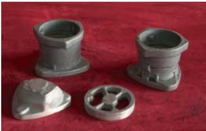
**Sopra, questi apparati, in configurazione grezza di fusione, sono due modelli di spinterogeno per il propulsore Alfa Romeo adatti al montaggio sulla Giulia GTA 1600, GTA 1300 e GTAm 2000; il distributore d'accensione si differenzia dagli altri modelli costruiti dall'Alfa Romeo perché il motore era dotato di doppia accensione.**
