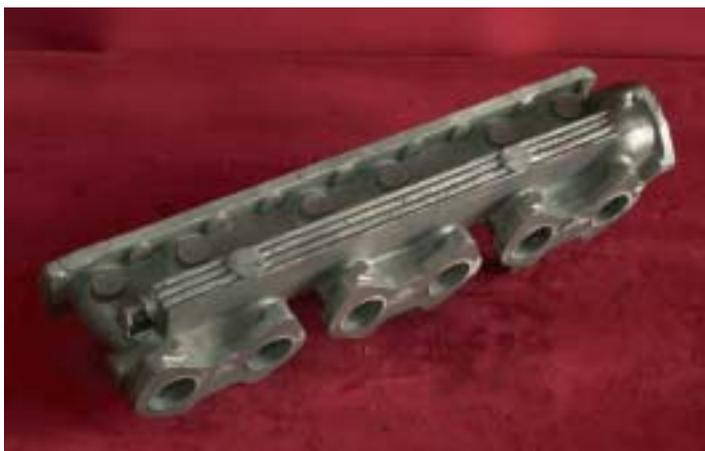
**Al centro, questo collettore di aspirazione è adatto al montaggio della batteria di alimentazione del propulsore a sei cilindri in linea della Jaguar E, sia nella versione di 3871 cm<sup>3</sup> che in quella di 4235 cm<sup>3</sup>.**
