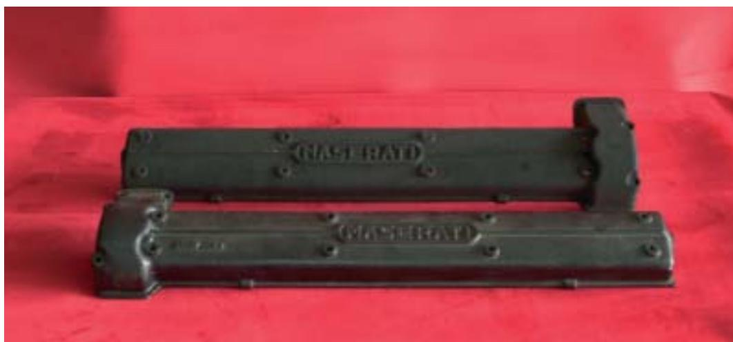
**La trasformazione del propulsore di serie adottato sulla Maserati 3500 GT, passando dall'alimentazione con iniezione meccanica alla versione dotata di carburatori Weber 42 DCOE, viene effettuata utilizzando i particolari rappresentati in queste immagini; il kit consente una rapida ed efficace sostituzione di tutti i particolari ricostruiti con fedeltà e cura. La sostituzione dei coperchi delle punterie si rende necessaria per eliminare il supporto di sostegno della pompa meccanica Lucas.**
