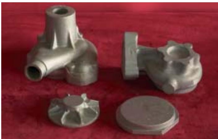
**Sotto, questi componenti, alla fine delle lavorazioni apportate mediante fresatura e tornitura, si trasformeranno negli apparati di pompa acqua per propulsori Abarth e per il motore della Maserati 3500 GT.**
