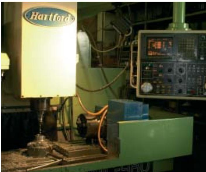
Sopra a sinistra, la finitura del cielo e della parte interna degli stantuffi viene effettuata utilizzando una fresatrice a controllo numerico, dotata di una speciale morsa per la presa del particolare da lavorare.
