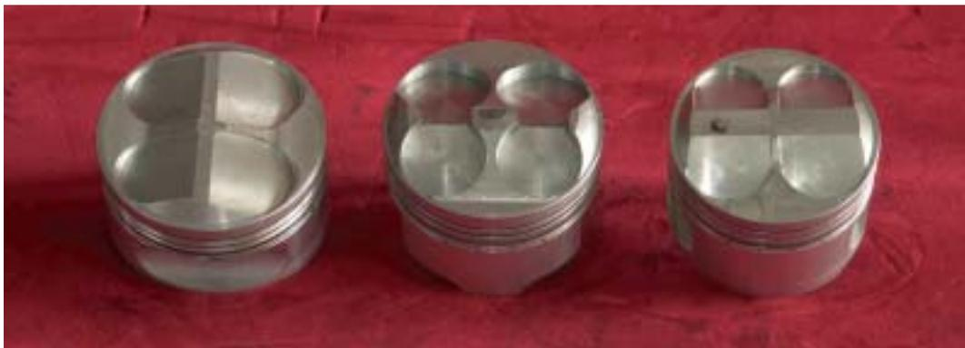
**Sotto, alcuni pistoni speciali, realizzati mediante forgiatura; questi pezzi sono destinati a propulsori dotati di quattro valvole per cilindro. Tra i componenti visibili nell'immagine si riconosce un elemento adatto al motore della Fiat 131 Abarth preparata secondo le specifiche "Gruppo 4" e alle più moderne Renault Clio 16 valvole preparate per i rally, realizzati secondo disegni differenti.**
