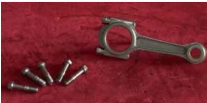
Sopra, queste bielle, realizzate in acciaio Impax, appartengono al propulsore della Ferrari 275; le viti speciali sono adatte alle bielle adottate sul propulsore della Lancia Fulvia HF da competizione.
